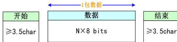
如果有一个中断服务程序连接到接收信息完成事件上，串口接收到一包数据时，无线 PLC 会产生一个中断（对端口 0 为中断事件 0，对端口 1 为中断事件 6）。
